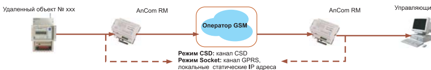
Рис. 10. Организация связи между двумя точками — радиоудлинитель интерфейса
