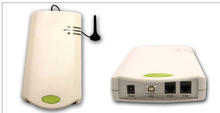
Рис. 2. Пример шлюза 3G-ТфОП с портами для станции и телефона
