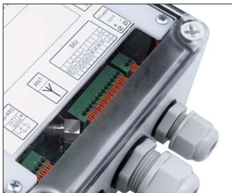
Рис. 6. GSM-модем AnCom RM/K: четыре дискретных входа телесигнализации; четыре дискретных выхода телеуправления
