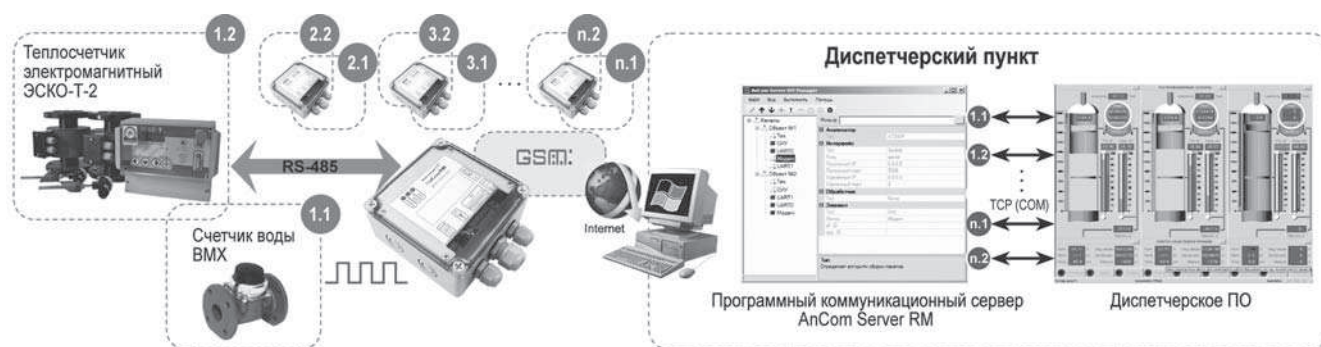
Рис. 6. Удаленный сбор данных с расходомеров разного типа по GPRS/EDGE-каналу.
