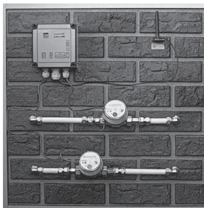
Рис. 4. GSM модем с автономным питанием AnCom RM/K. Макет узла учета расхода воды (расходомеры с импульсными выходами)
