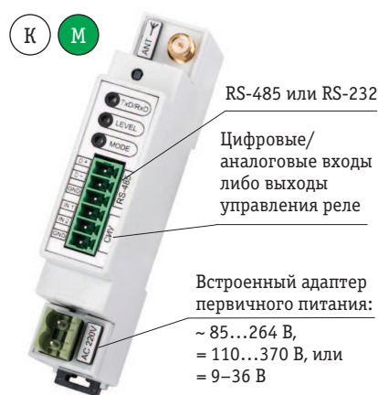
Рис. 1. ZigBee Pro-модем AnCom RZ/B. Крепление на DIN-рейку; диапазон температур: -40...+70 °C
