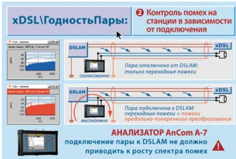
Рис. 7. Контроль и анализ источников помех на станционной стороне
