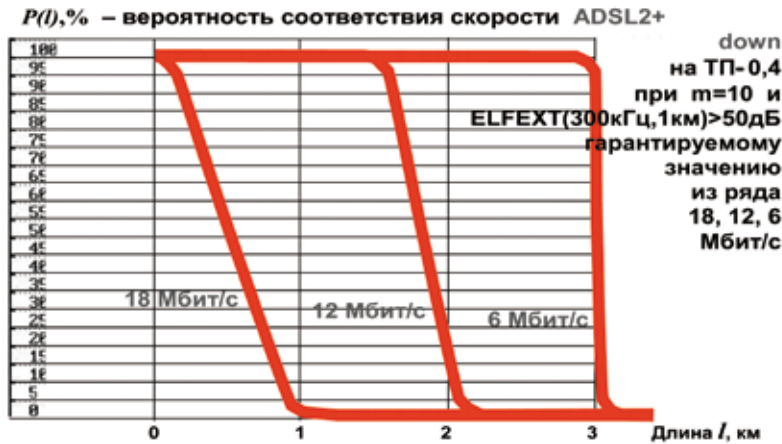
Рис. 4. Изменение вероятности соответствия скорости ADSL2+ заданному значению в зависимости от длины линии
