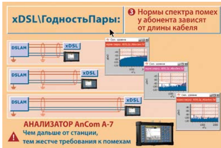
Рис. 8. Контроль помех в распределительном шкафу, в распределительной коробке или на абонентском окончании в зависимости от длины кабеля
