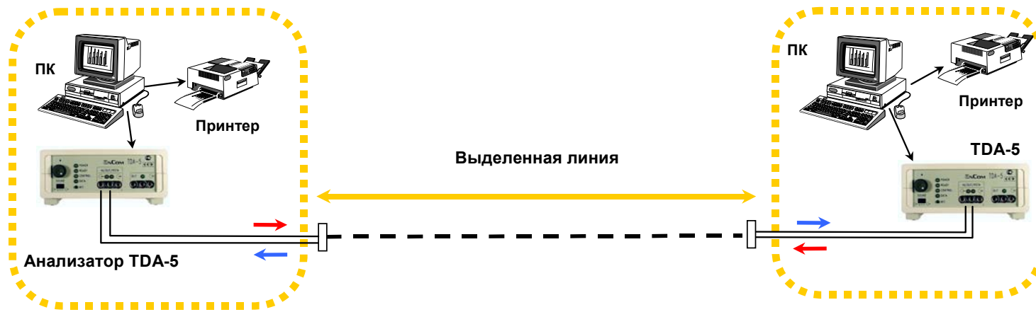
Рисунок 2 а . Измерение выделенной линии с применением двух анализаторов
