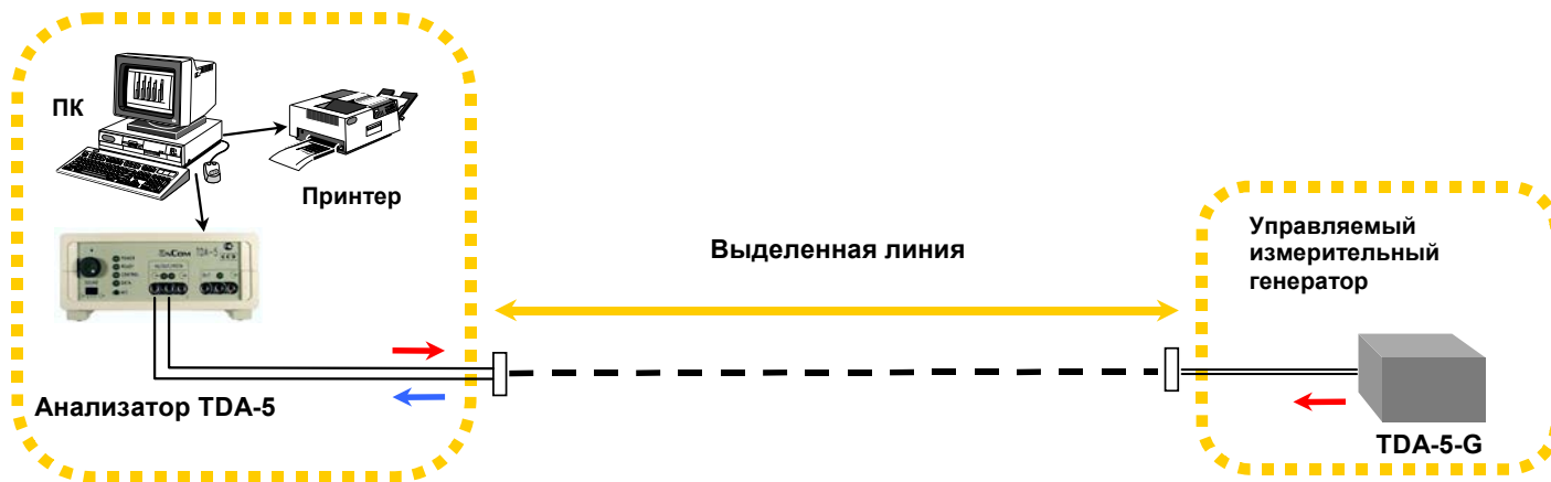
Рисунок 2 б . Измерение выделенной линии с применением управляемого генератора в удаленной точке
